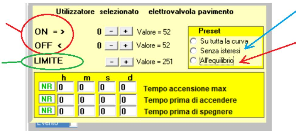
(punto di equilibrio, linea rossa tratteggiata) il relè elettrovalvola pavimento si attiverà. Come sappiamo un riscaldamento a pavimento non è così veloce come risposta, per cui, per non aspettare i tempi di assestamento, vogliamo coadiuvarlo con il ventilconvettore.
