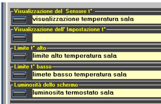
Sotto le voci viste, troveremo l'eventuale impostazione dei limiti entro cui sarà possibile settare il range di regolazione (utile per esempio in caso di strutture, camere per anziani o bambini, esigenze particolari etc.). Troviamo infine la possibilità di regolare la luminosità dello schermo, se si desiderano luminosità differenti per il giorno o la notte o altra situazione legate a scenari particolari. Ne tratteremo l'operatività dopo.
