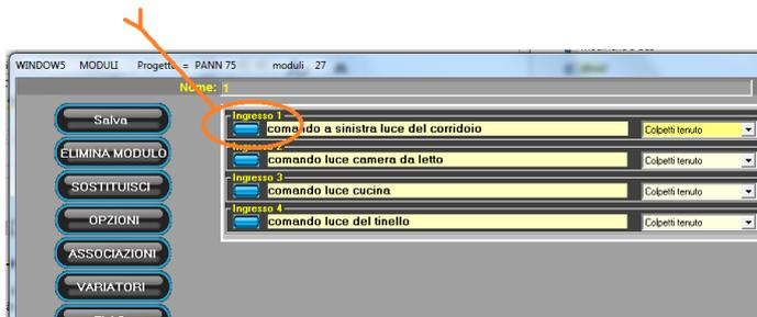
È possibile, cliccando sul pulsante funzioni accanto alla label, personalizzare il comportamento della funzione colpetti, ovvero è possibile stabilire quanto tempo il sistema aspetta il secondo colpetto. È normalmente settato a 5 decimi, ovvero 0,5”, ma in quasi tutti i casi possiamo abbassare questo tempo a 3 decimi; con un tempo minore il sistema è
