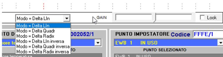
riscaldamento (il valore aumenta col diminuire della temperatura); questo si ottiene mediante la combo **modo**. Attenzione. Se il check **look** è attivo, queste operazioni sono bloccate per sicurezza. Questa funzione si attiva da sola una volta impostati i primi parametri, per cui occorre sbloccarla con un click
