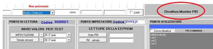
Cliccando su attiva monitor PID possiamo vedere in tempo reale lo stato del pid, i valori impostati e pervenuti della temperatura, impostare valori di comodo per i test etc. ovviamente per questa funzione occorre essere connessi
