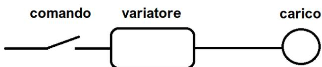
vedere, un organo di comando comanda il variatore che a sua volta pilota il carico a seconda delle impostazioni, ovvero della relazione stabilita tra modo di comando e risultato voluto. Normalmente un impulso breve attiva e disattiva il carico, mentre
